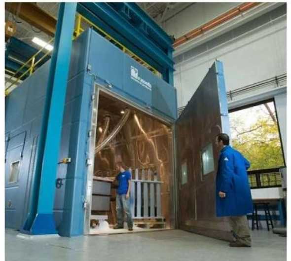
Het Center for Innovative Materials Research van de Lawrence Technical University in de VS test al bouwmaterialen in een klimaatkamer. De UHasselt plant de bouw van een gelijkaardig labo. FOTO RR
